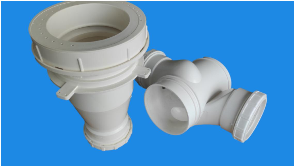
3S聚丙烯[PP]静音排水管道系统：管材内外层均采用以耐冲击共聚聚丙烯[PP-B]树脂为主要原料，中间层为降噪吸声材料，采用三层共挤成型；管件以降噪吸声材料和耐冲击共聚聚丙烯[PP-B]材料共混料，承口经整体一次注射成型；采用柔性承插连接，施工快捷方便，强度更高，有降噪声、高抗冲、耐低温、耐高温、耐腐蚀等优良化学物理性能，响应国家“节能减排、以塑代钢”的指导方针和政策。愿为每一个家庭建设一个美丽的家园竭尽微薄之力。
